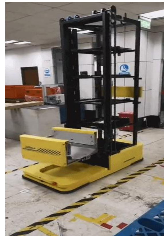
ビンを抱えて持ち上げる機能 サイドフォークをサポートし、作業効率が向上
