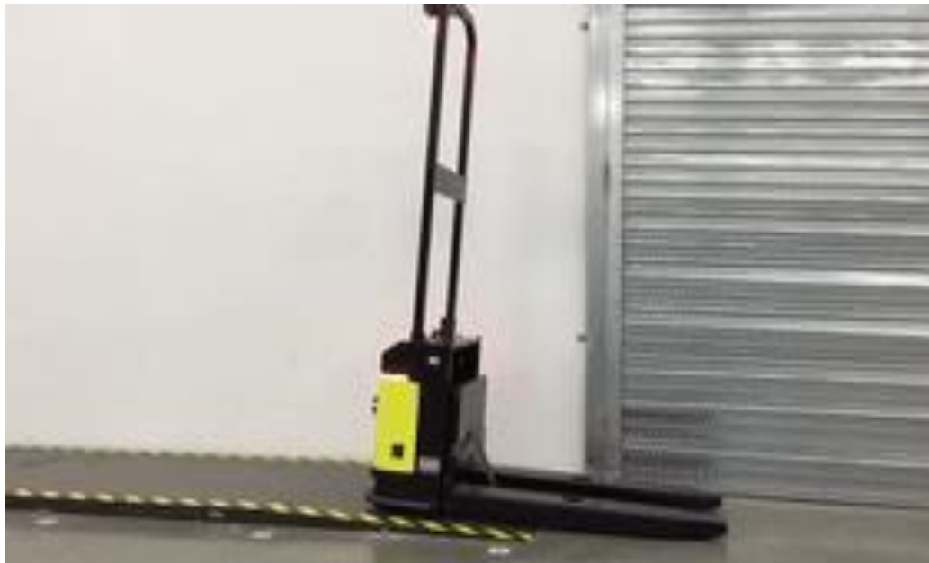
無負荷で斜面登りテスト テスト目的: 無負荷で8°の登り能力を持つ
