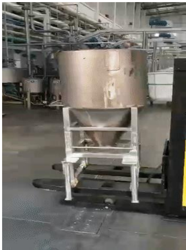
ロードとリフト機能 高度1 mまでの積み上げ
