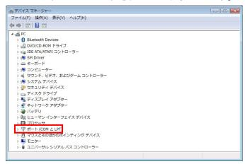
4. "USB Serial Port (COM X)と表示されていれば ドライバは正常にインストールされています。 ※X:番号(PCの使用状況により異なります)
